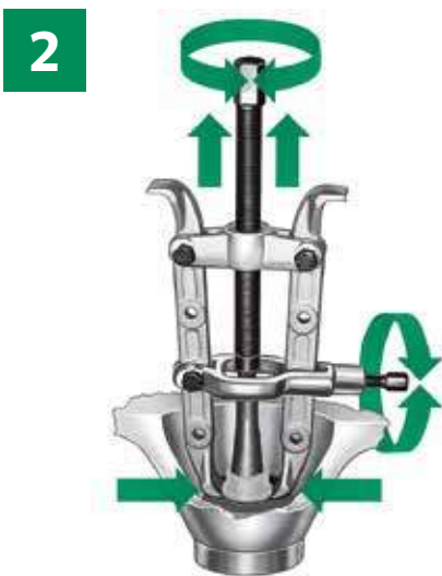
Принцип функционирования двухрычагового съёмника
