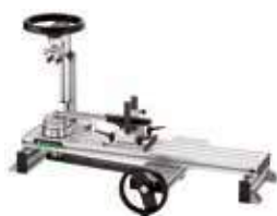
Механическое нагружающее устройство с переходным фланцем
